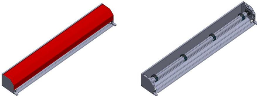
Emboîter les coulisses sous les flasques d'enroulement en respectant le sens de montage.
