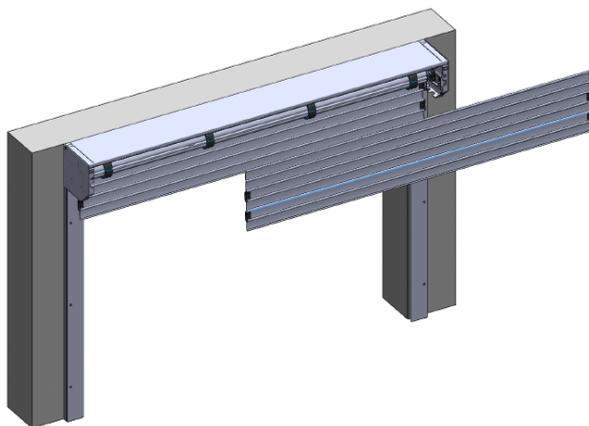
Dans le cas d'une option tablier préassemblé, glisser le tablier dans les 5 premières lames prémontées.
